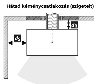
A füstcső áthaladása éghető anyagból készült falon
