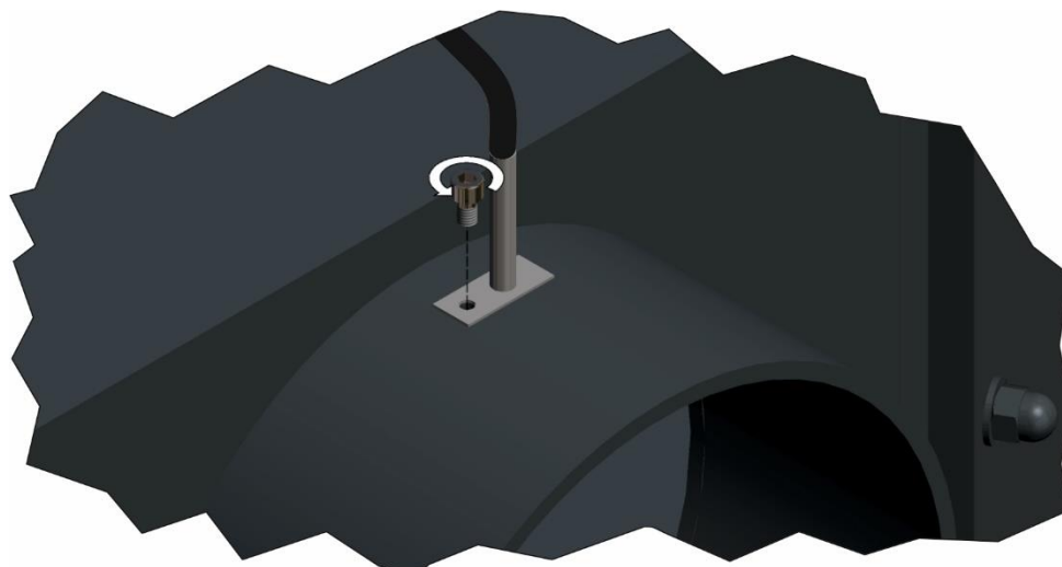
Rysunek 10. Sposób demontażu czujnika temperatury spalin.
