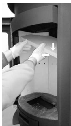
4. Pootočit a vysunout betonový deflektor.
