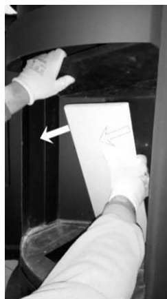
8. Entfernen Sie die hintere Beton-Platte.
