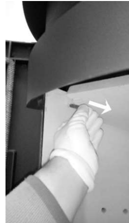
3. Ziehen Sie den Stift der Umlenkplatte heraus. Auf beiden Seiten.
