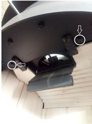
1. Dévisser les vis de fixation.
