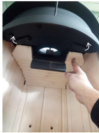
2. Déverrouiller les manettes du déflecteurs.
